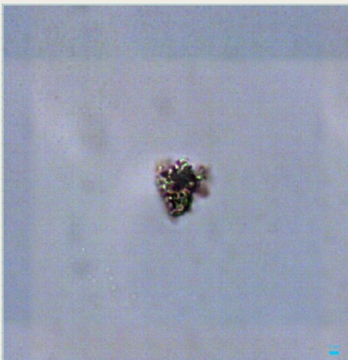
▲ Immagine di particelle simili al grafene acquisita con luce trasmessa e obiettivo 100x
